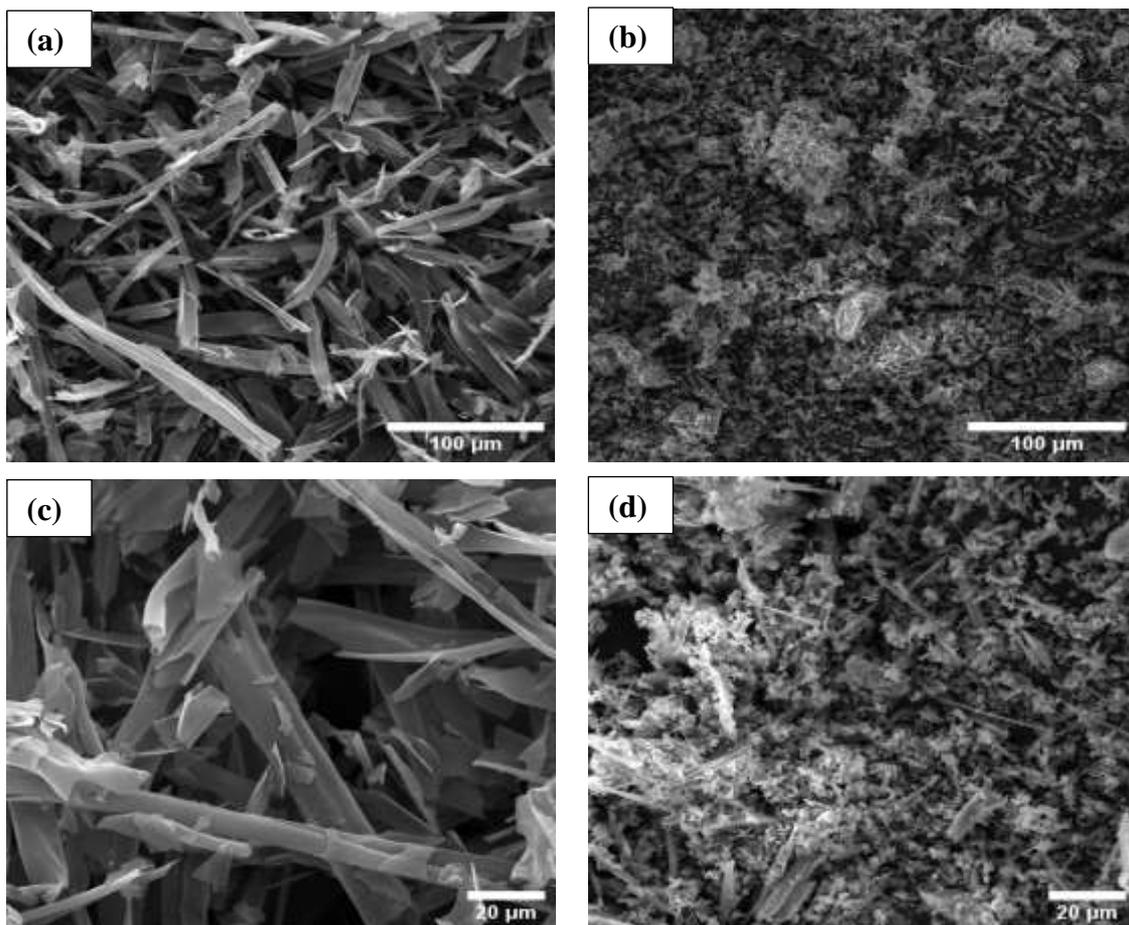
**Figure 2.** SEM images of (a) KF; 400x (b) MCC; 400x, (c) KF; 1Kx (d) MCC; 1Kx.
